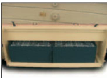
Un caricabatterie digitale di bordo completamente automatico, da 220 V e 50 A, aiuta a ottenere prestazioni ottimali dalla batteria. Questa è ulteriormente assistita da un'interruzione di funzionamento in caso di carica bassa per evitare lo scaricamento eccessivo delle batterie.
